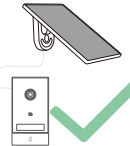
Memastikan kabel terpasang secara alami tanpa tegangan
