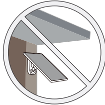
Hindari naungan dari atap bangunan
